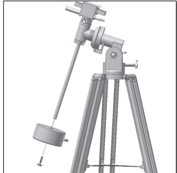
Abb. 5. Befestigen des Gegengewichts, Einschoben des Gegengewichts.
