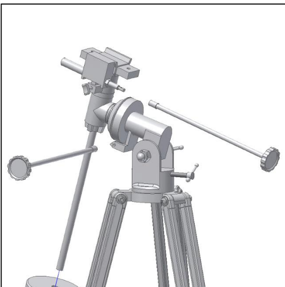
Abb. 6. Befestigen der Deklinations- und Rektaszensionsgriffe.
