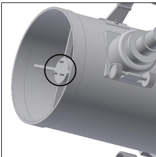
Abb. 25. Einstellschrauben des Sekundärspiegels.
